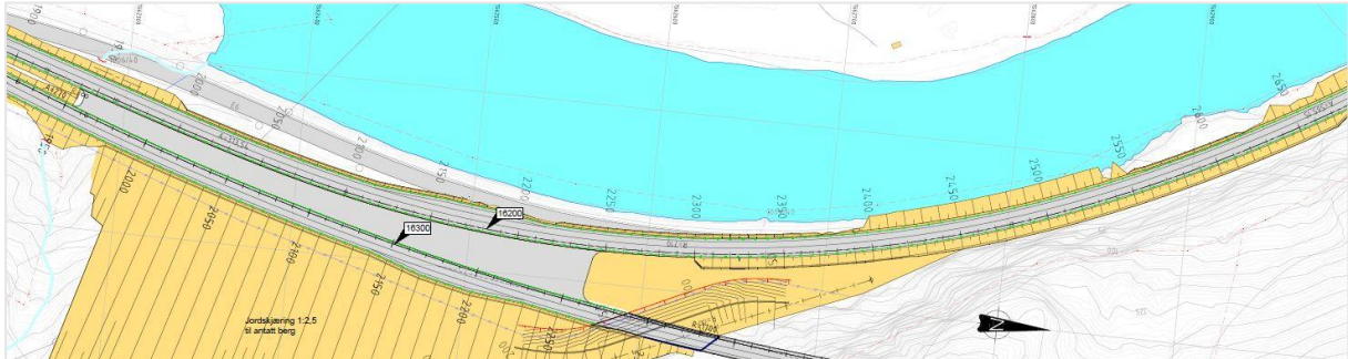
Figur 3-7 Utbedring av eksisterende E6 med vegfylling ut i Gaula og behov for erosjonssikring.
