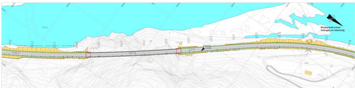
Figur 3-8 Utbedring av eksisterende E6 ved Brattlitunnelen. Vegfylling i Gaula og behov for erosjonssikring.
