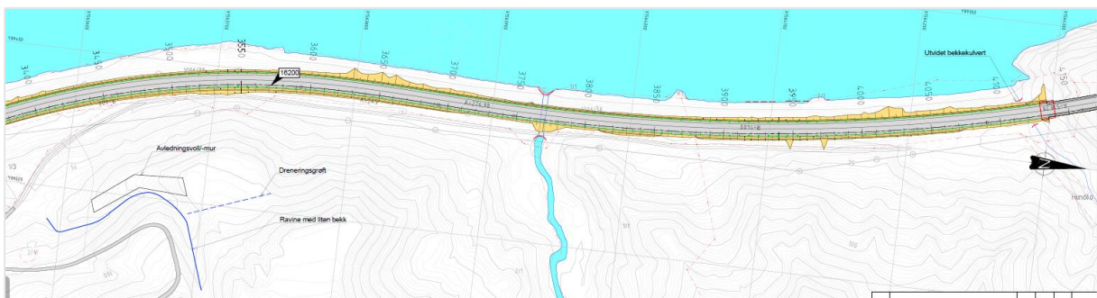
Figur 3-9 Utbedring av E6 sør for Håggåtunnelen med tiltak for å styre overvann og redusere rasfare.
